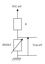
$Vout (mV) = VCC (mV) * HS24LF (\Omega)$  $R (\Omega) + HS24LF (\Omega)$
